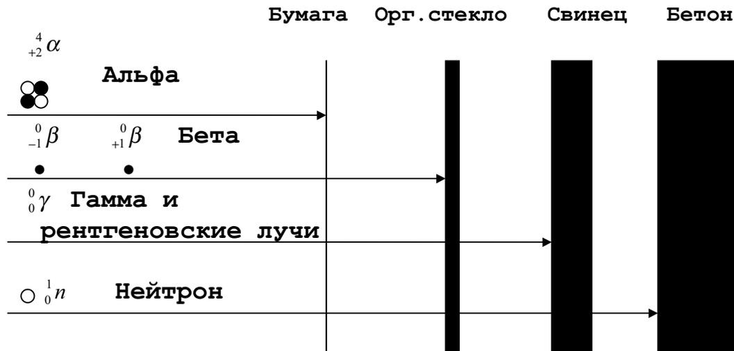
Рис.1-1. Проникающая способность разных видов ионизирующего излучения.
